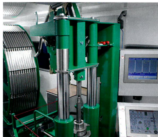
De gegevens van de digitale conus worden automatisch in de software ingelezen.
