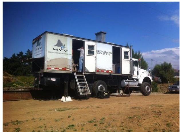
Fig. 12. 23 ton CPT truck.
