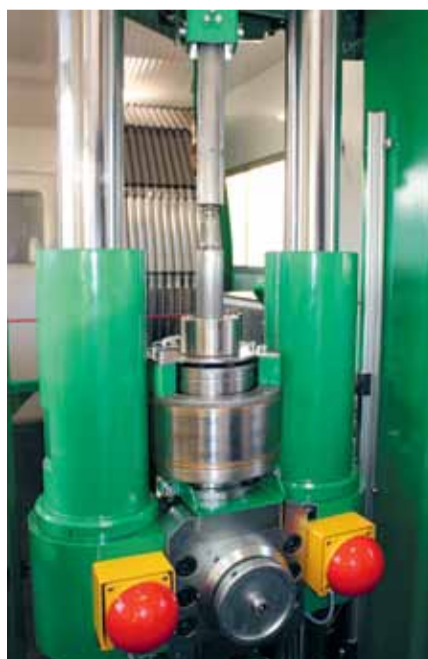
Om het systeem goed te laten functioneren is een speciale zelfzoekende snelkoppeling ontworpen. Met een korte draai wordt de ene buis geautomatiseerd aan de andere gekoppeld.
