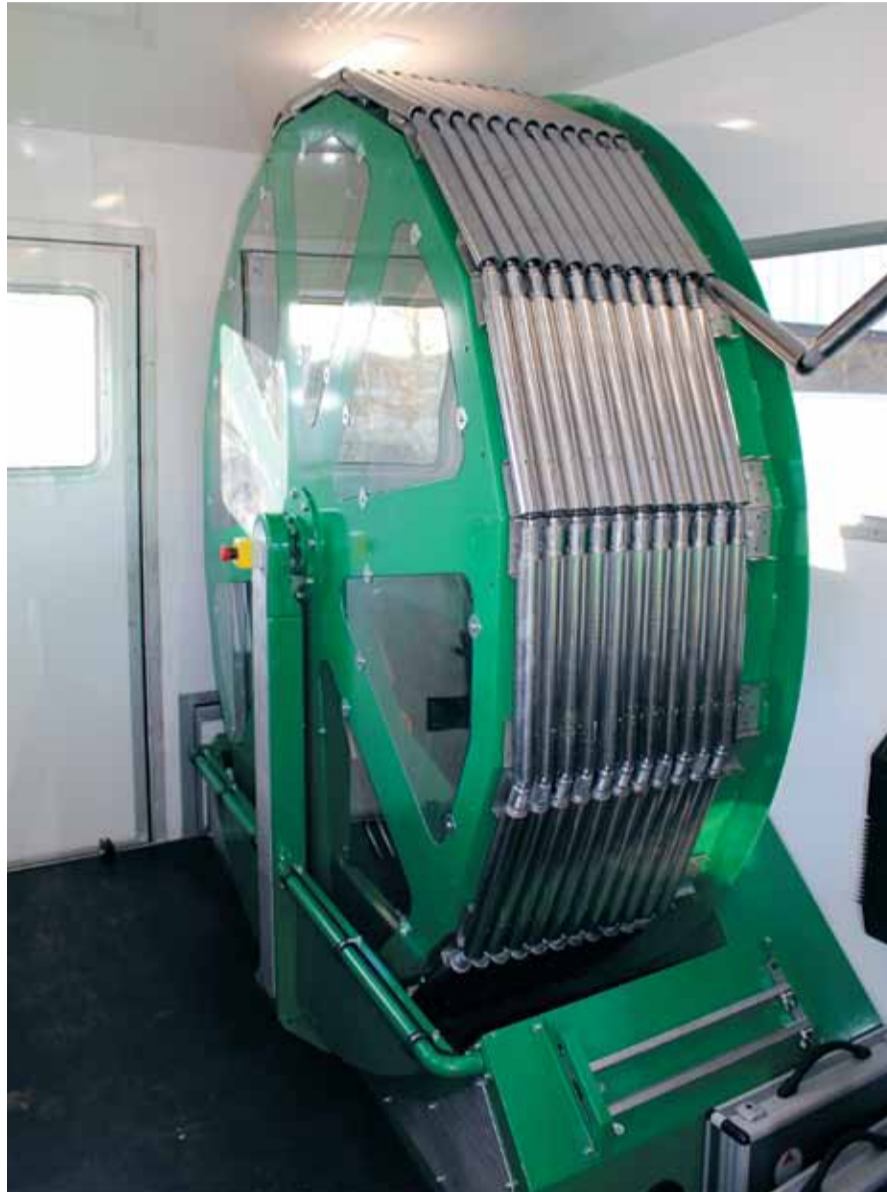
De buisdelen worden bij het afrollen van de haspel geautomatiseerd aan elkaar geschroefd en vervolgens (ook geautomatiseerd) in de persinstallatie geleid en de grond ingedrukt.
