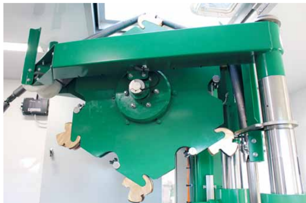
Om het systeem goed te laten functioneren is een speciale zelfzoekende snelkoppeling ontworpen. Met een korte draai wordt de ene buis geautomatiseerd aan de andere gekoppeld.
