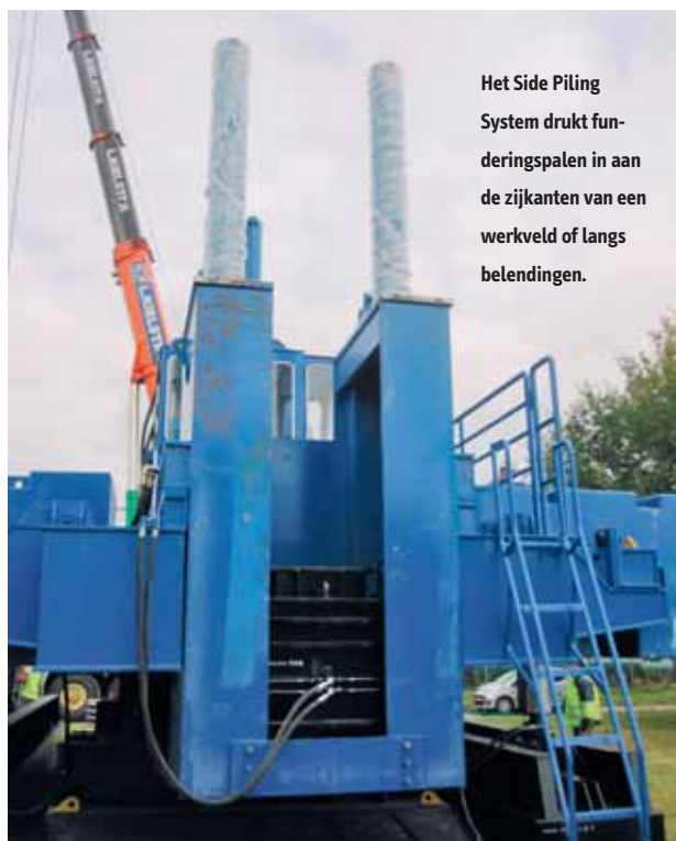
◀ Om de indrukkraft naar wens te vergoten is de machine te verzwaren met een flexibel aantal contragewichten
