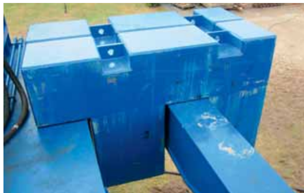
◀ Om de indrukkraft naar wens te vergoten is de machine te verzwaren met een flexibel aantal contragewichten
