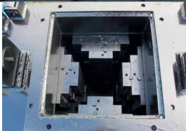
◀ De hydraulische klem is met meer of minder klemblokken in te stellen voor ieder paaltje en -diameter.
