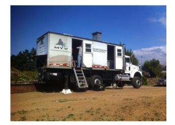
Fig. 12. 23 ton CPT truck.
